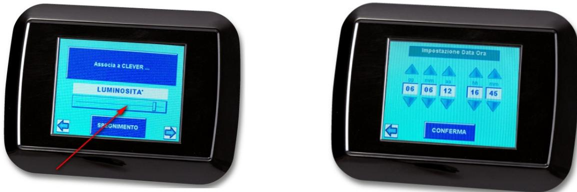
Qualora il CLEVER BOX non fosse connesso ad Internet, la regolazione dell'ora sul CLEVER VIEW può essere effettuata sulla apposita maschera di "Impostazione data ora". In caso di blackout o di interruzione di alimentazione al CLEVER BOX sarà necessario reimpostare nuovamente l'ora. Senza l'impostazione dell'ora il CLEVER BOX non memorizza i dati storici dell'impianto.
