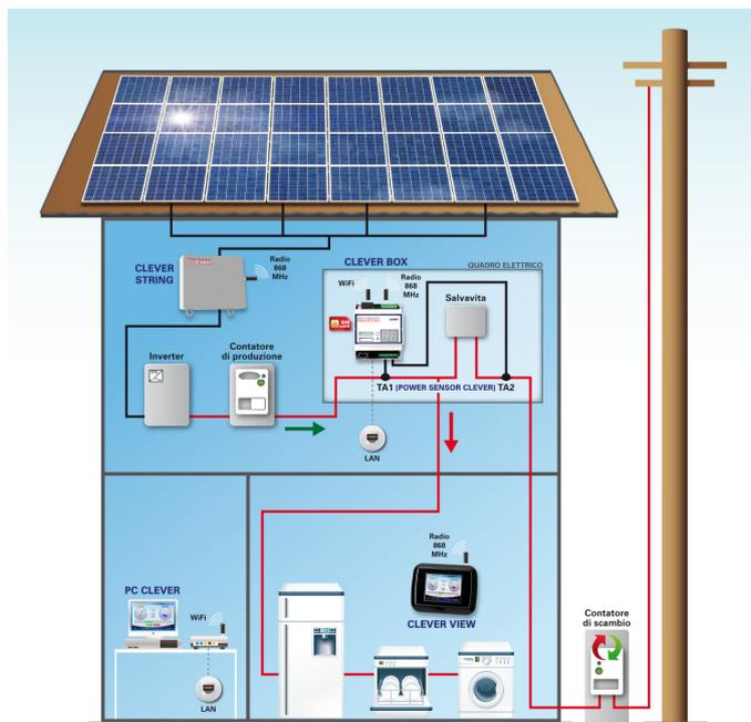
**IMPORTANTE:** Si raccomanda di prevedere un sezionatore con fusibile da 2A a monte del CLEVER per protezione e per poter togliere alimentazione all'apparato.
