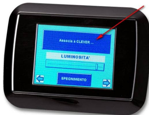
3. Portarsi nelle vicinanze della CLEVER BOX. Durante la fase di registrazione nel display del CLEVER BOX comparirà l'indicazione r2 mentre tornando al pannello principale comparirà il simbolo della connessione radio.
